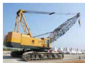
Máy cầu bánh xích Crawler crane
